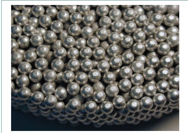
Figure 1 – Un des échantillons utilisés pour l'observation de la localisation d'Anderson des ondes élastiques. Il est composé de billes d'aluminium de 4 mm de diamètre, brasées pour former un réseau élastique désordonné.
