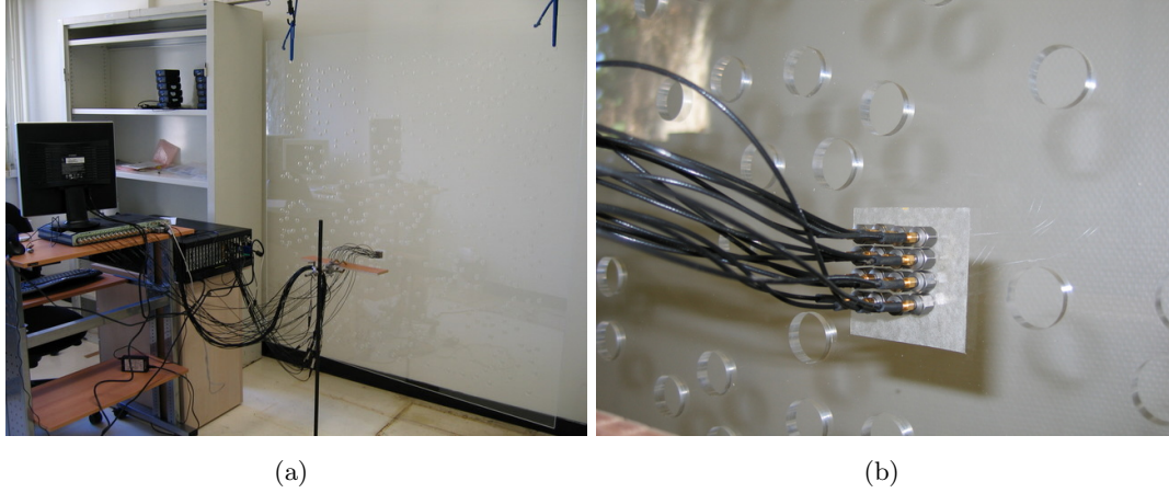
Fig. 5.1: Dispositif expérimental photographié lors de tests préliminaires. (a) Une plaque de Plexiglas®, perforée aléatoirement de cavités cylindriques, est suspendue par des tendeurs afin d'avoir des conditions de bords libres pour les ondes de flexion. (b) Gros plan sur les accéléromètres utilisés, ici disposés en carré 4 \times 4 et collés avec de l'adhésif double face. Le collage des récepteurs sera par la suite réalisé par de l'acide phénylsalicylique réalisant un meilleur couplage.
